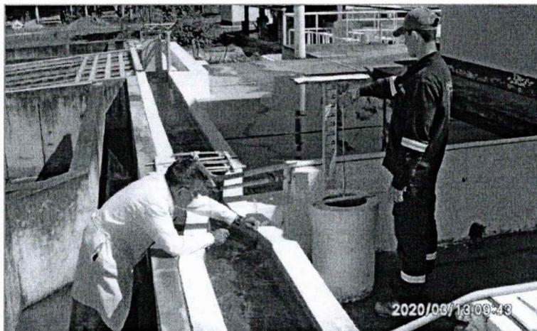
Calibración del instrumento para medir caudal
