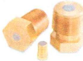
El metal del fusible se funde entre 70° y 73. 9°C por lo que casos fuego o exposición a temperaturas elevadas, se libera la presión, previendo la rotura del recipiente; estos tapones no deben calentados ni alterados; si uno de ellos abriera, todo el cloro del cilindro escaparía con gravísimas consecuencias.
