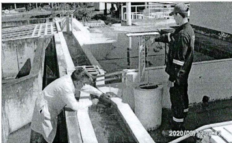
Calibración del instrumento para medir caudal
